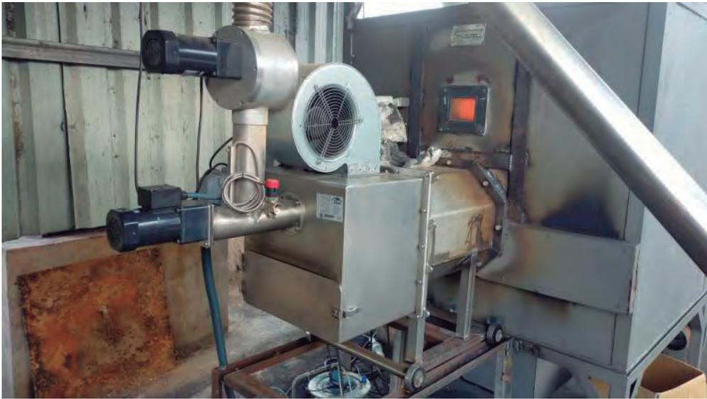
Imagen 2: Quemador de biomasa instalado.
